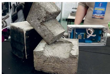
Образец «наномодифицированного высокопрочного легкого бетона на композиционном вяжущем».
